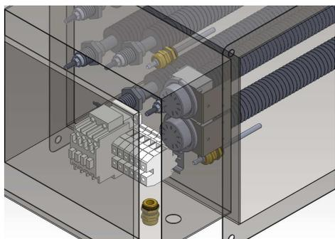
Riscaldatore con resistenze corazzate alettate inox montato su tronco di canale rettangolare in lamiera zincata completo di:
